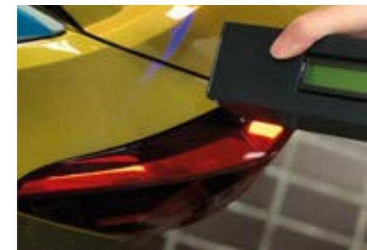
SCANNER LASER PORTATILE PER ALLINEAMENTO PARTI ADIACENTI
